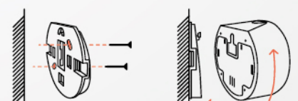
3. 牆面支架安裝 (安裝高度: H \leq 2.4m )
